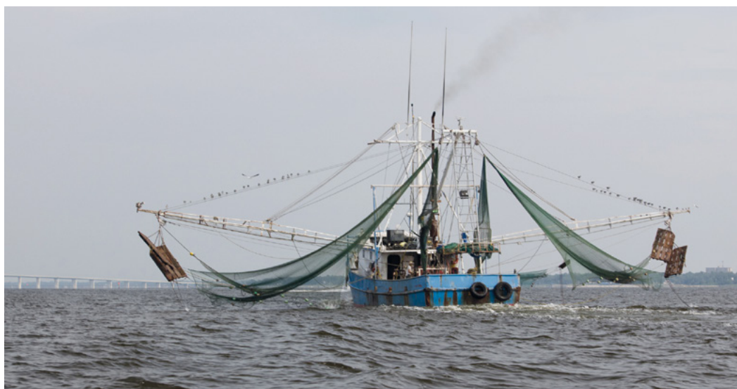
Figura 9. Barco camaronero con una red de arrastre con portalones en cada banda (© istockphoto-503378039)
