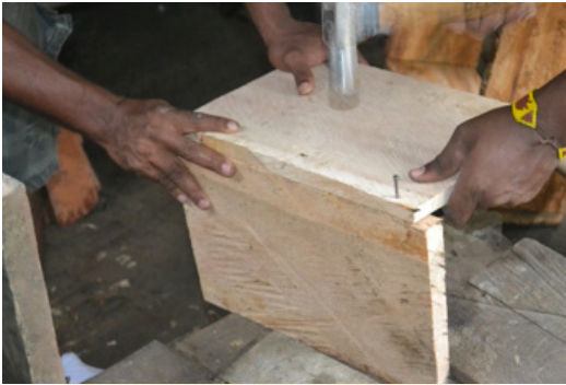
2 Armado de las patas con tablas
