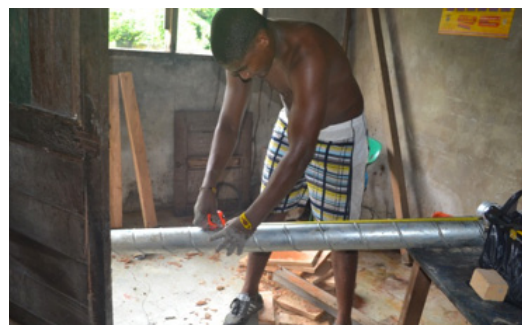
43 Proceso de medir el tubo
