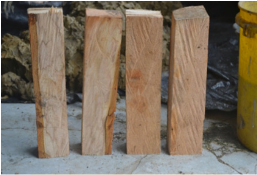
1 Patas de guayacán de 35 centímetros de largo
