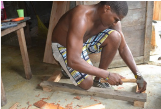
5 Armado del soporte (unión de patas con largueros de guayacanes).
