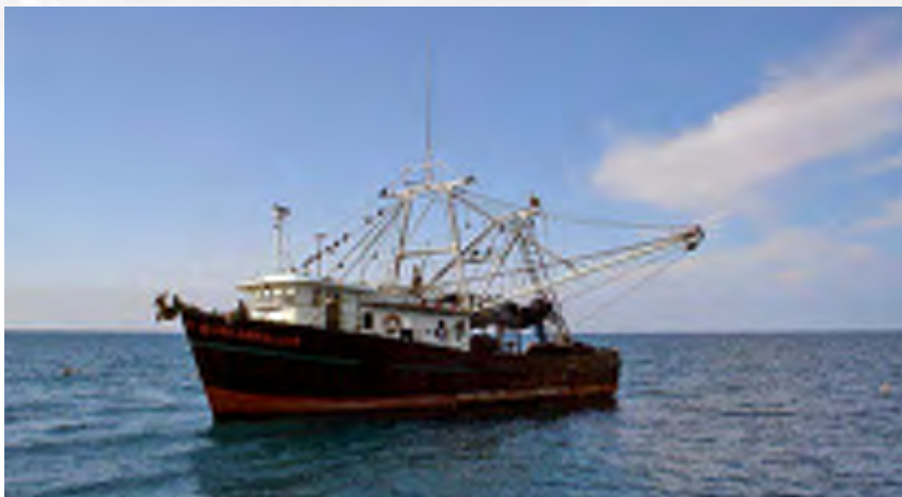
Foto 2. Barco camaronero que usa el sistema de pesca de arrastre con doble aparejo para la captura de camarón de aguas someras en el Pacífico colombiano.
