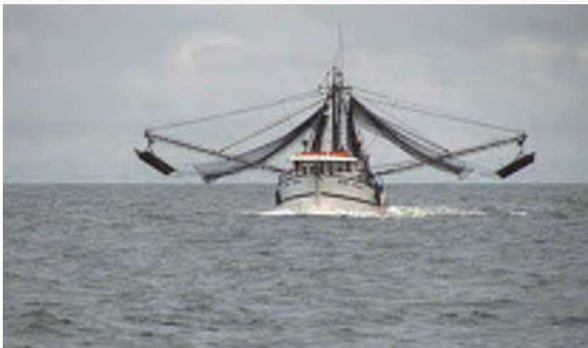
Foto 2. Barco camaronero de aguas profundas en el Pacífico colombiano. Se muestran los tangones, redes y puertas de arrastre a cada lado de la embarcación.
