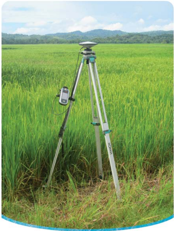
Fotografía 21. Se utilizó un sistema de corrección diferencial (con estación base -en imagen- y unidades de captura en campo o “rover”).
