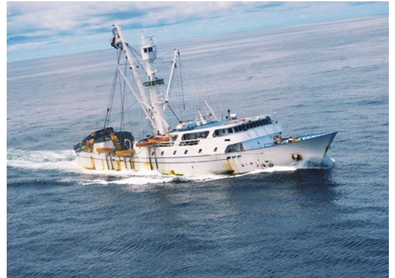
Figura 1.3. Los modernos atuneros de cerco, son potentes embarcaciones con alta tecnología y capaces de operar redes de hasta 200 m de alto (profundidad) y 1.500 m de circunferencia (Foto: Melisa Ramírez E.)
